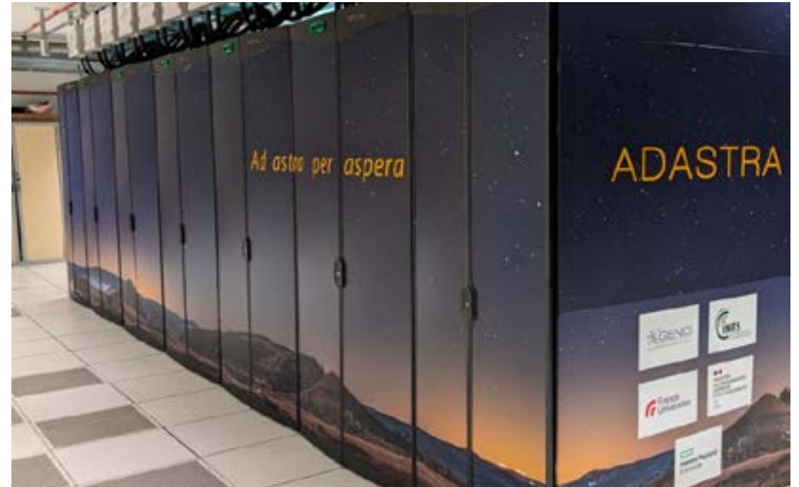
Avec 46 PFlop/s et 58 GFlops/Watt, le supercalculateur Adastra au CINES est classé 3 ème au classement Green500, et 12 ème au Top500.
